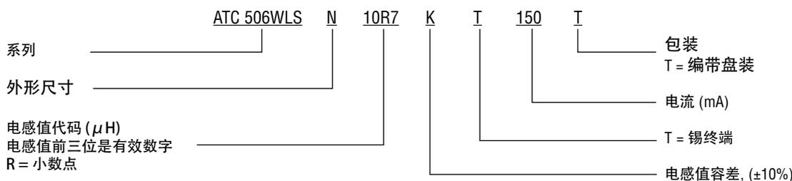
以上是ATC 506WLS系列 外形尺寸 N, 10.7 μH电感器型号说明, K容差(±10%, 典型值), 锡终端 (T), 150 mA, 编带盘装。
